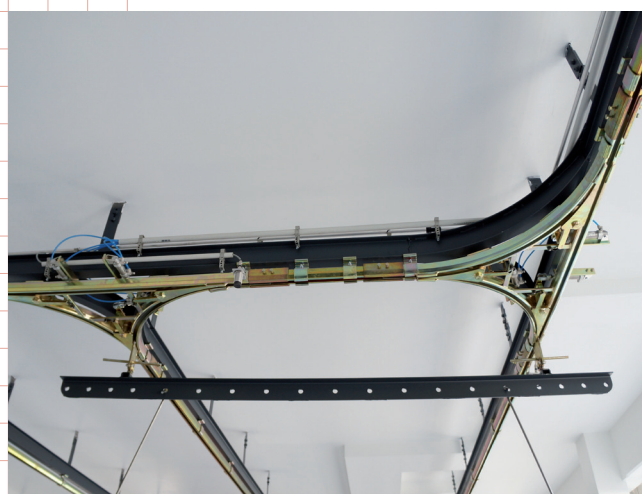
materiálový tok řízený pomocí kombinace výhybek
