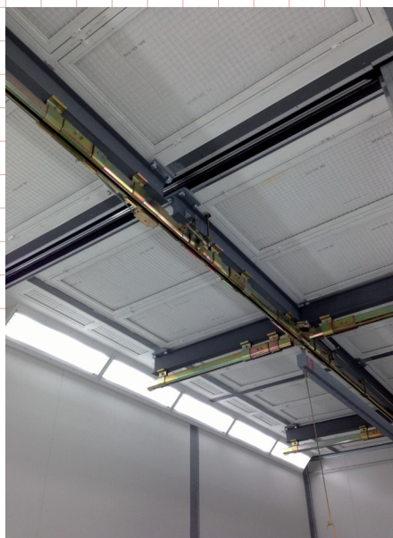
výhybka otočná pro třídění jednotlivých produktů
