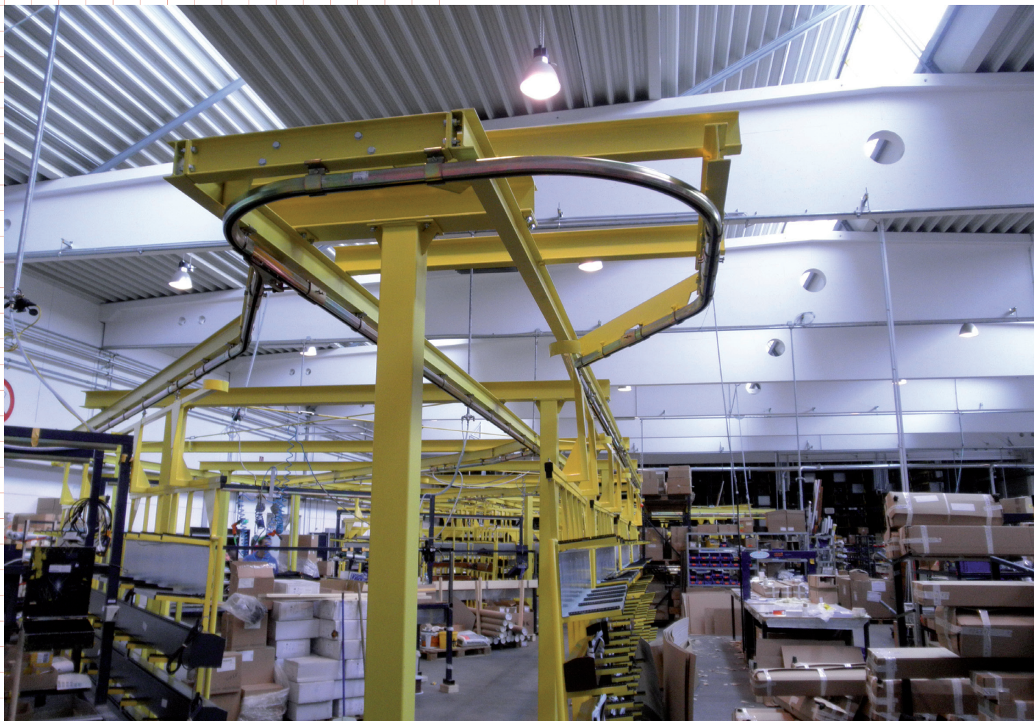
podvěsná dráha pro výrobu žaluzií
