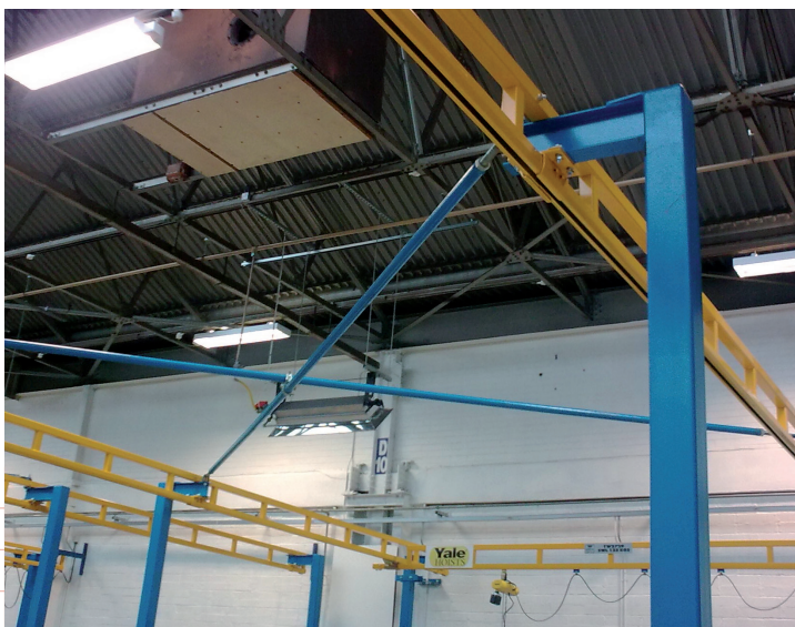
vyztužení dráhy pomocí táhel
