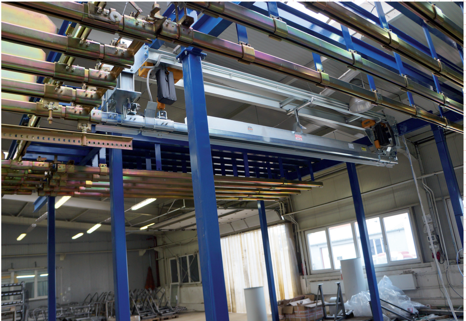
spouštěcí stanice do 1.600 kg a rozpětí do 6.000 mm
