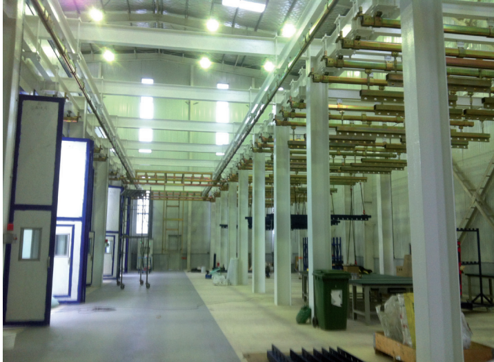
Přesuvna s nosností 1.600 kg
