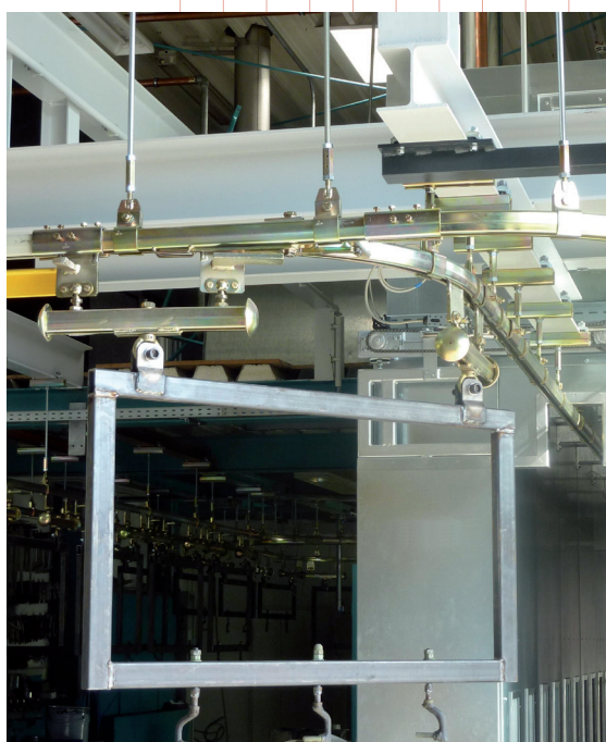
zásobník traverz s elektrickým pohonem
