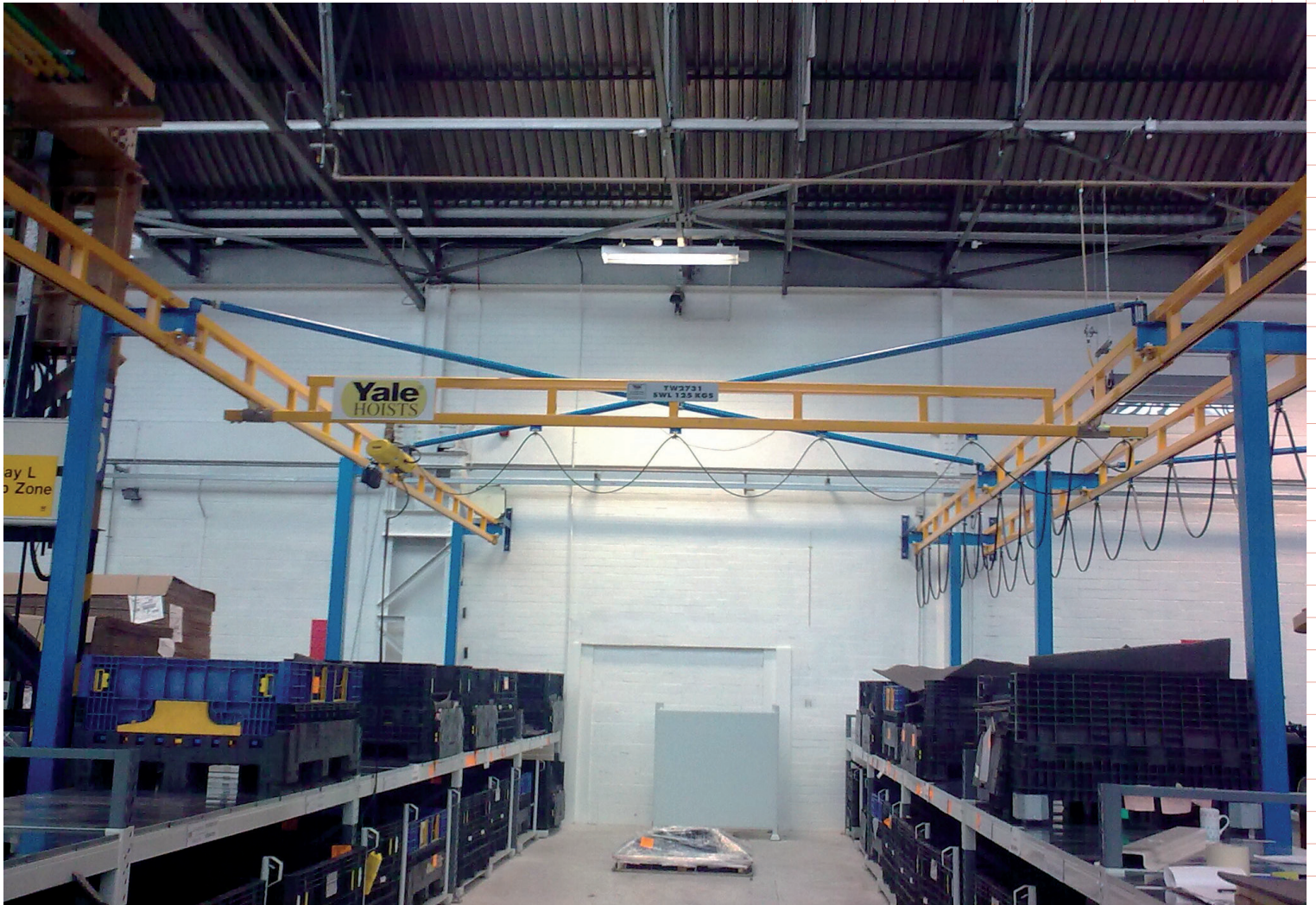
nízká výška příhradové konstrukce při rozpětí 8 m
