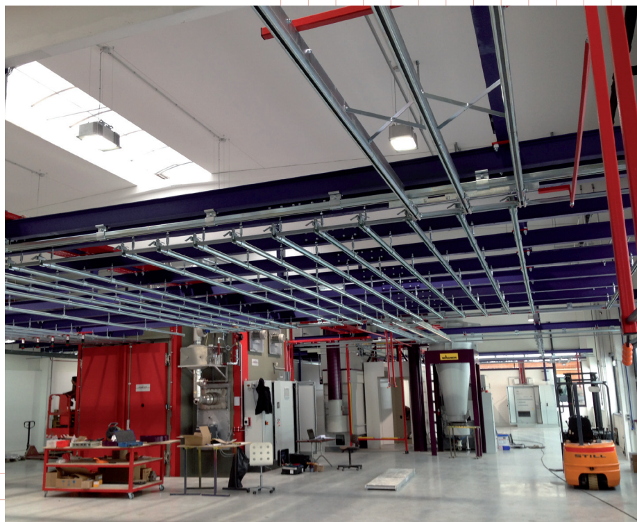
zavěšení dráhy bez podpůrné konstrukce
